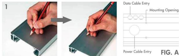
1 Segnare sul retro del binario la posizione dove applicare il foro con l'utilizzo del trapano apposito. FIG.A illustra la posizione dei fori sul telaio.
