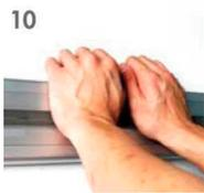
10 Inserire il binario SFC3 all'interno del telaio.
