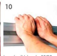
Inserire il binario SFC3 all'interno del telaio.
