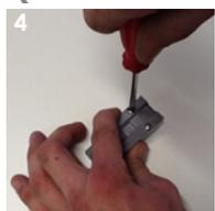
Ruotare il terminale e rimuovere le due viti con cacciavite a croce.
