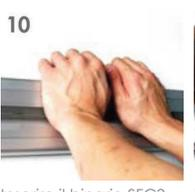
Inserire il binario SFC3 all'interno del telaio.
