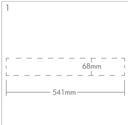
Preparare il contorno per il posizionamento del profilo 541 x 68 mm. Rimuovere i morsetti da Genesis's track.
