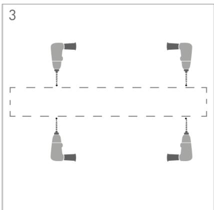
Praticare i fori per le viti di montaggio di diametro 4 mm.
