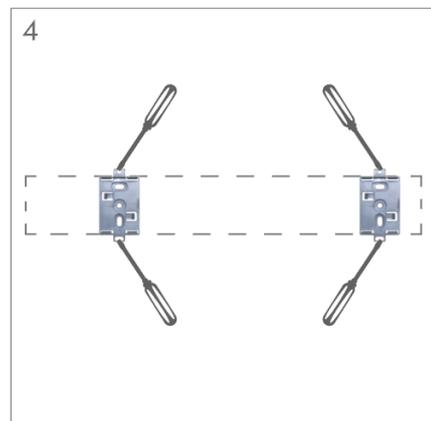
Fissare al muro i morsetti con le viti in dotazione.
